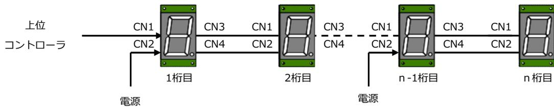
※ 1桁目の電源入力(CN2)の電流は3Aを限度としてください。
